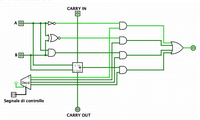
Utilizzo un decodificatore a cui collego due segnali di controllo per la scelta dell'operazione. Si richiede poi di svolgere 4 operazioni: per il complemento a 1 dell'operando A utilizzo un NOT; per verificare che A e B sono uguali utilizzo la porta logica NXOR (in questo modo nel caso A=0 e B=0 o A=1 e B=1 in uscita ho 1, negli altri casi 0); per l'operazione di AND utilizzo la porta logica AND e, infine, per la somma utilizzo un full adder con anche il carry in e il carry out per il riporto.
