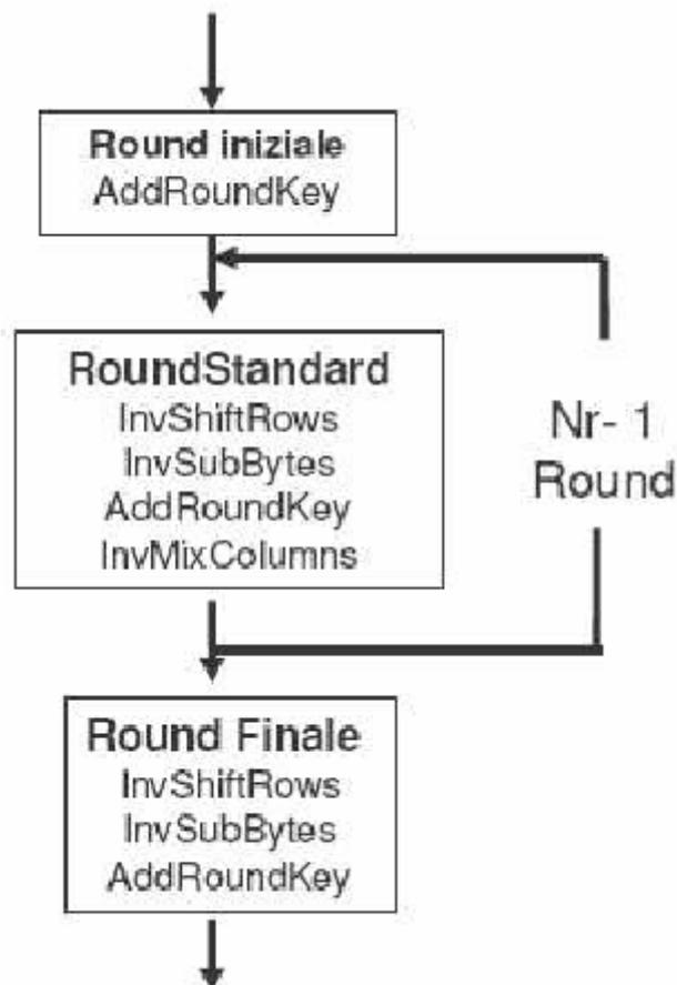
Un altro elemento invariante è lo schema dell'algoritmo, infatti nonostante le funzioni siano differenti, i round (passi) di InvCipher e Cipher conservano la stessa struttura: InvCipher implementa  $N_r$  round. Di questi  $N_r-1$  sono eseguiti ciclicamente, mentre il Round Iniziale e il Round Finale compongono un unico passo che comincia prima e termina solo dopo le iterazioni del ciclo.
