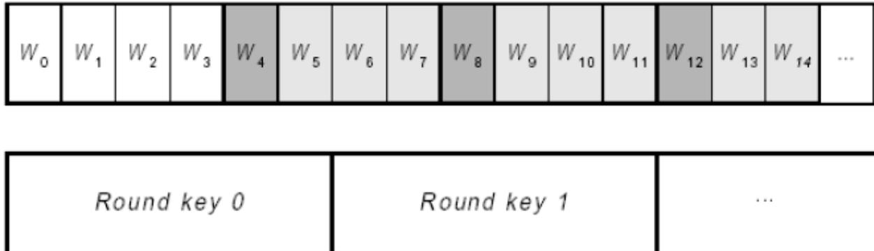
La costruzione dell'array  $W$  viene normalmente eseguita prima dell'esecuzione dell'algoritmo di cifratura, fornendolo quindi come parametro della funzione Cipher. E' tuttavia possibile un'implementazione in cui le Round Key vengono costruite ad ogni passo quando necessario. Di seguito viene mostrato lo pseudo codice del primo caso.
