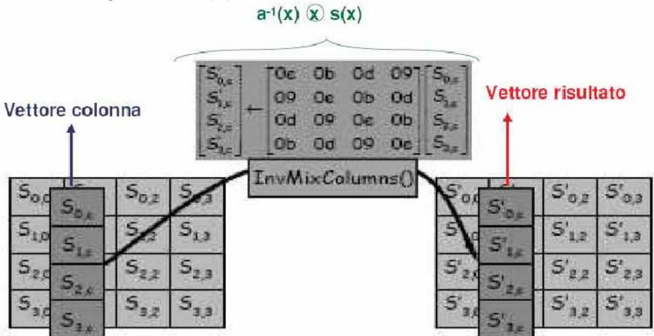
La funzione utilizza una particolare operazione matematica chiamata prodotto modulare, che consiste nella moltiplicazione del vettore colonna per un polinomio di terzo grado fissato, tutto riportato in modulo  $x^4+1$ . Il polinomio fissato è:
