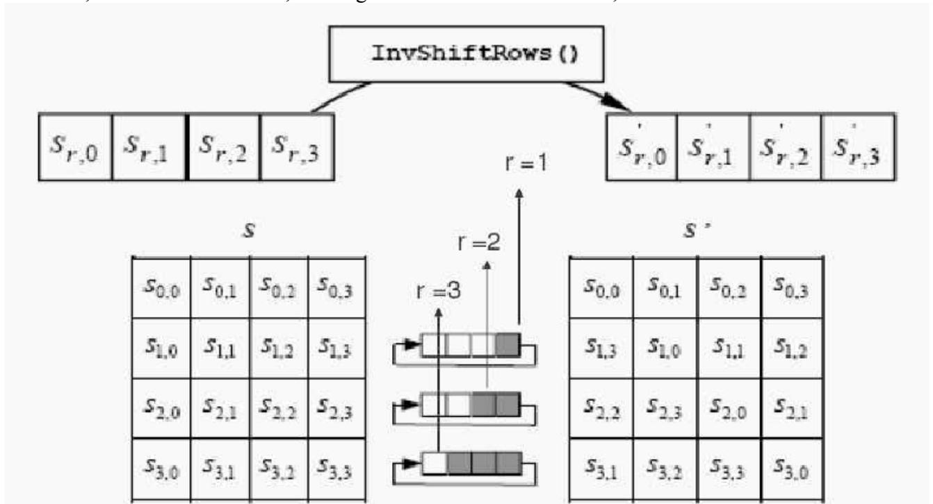
Osservando la funzione si nota che non è altro che la stessa di Cipher con il senso dello shift invertito:
