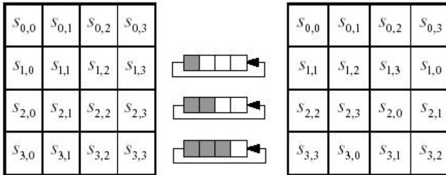
In pratica, la prima riga resta uguale (shift di zero posizioni), la seconda riga si muove verso sinistra di una posizione, la terza riga di due posizioni e la quarta riga di tre posizioni. L'operazione è modulo 4, quindi i byte che muovendosi a sinistra "escono" dalla matrice, rientrano da destra.
